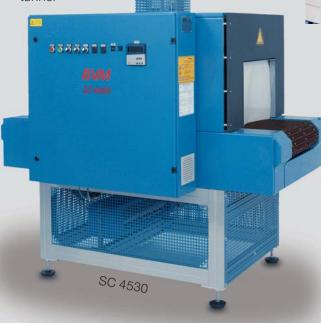
Des clapets de ventilation doubles permettent de régler séparément de l'extérieur du tunnel le flux d'air à l'intérieur de celui-ci.
