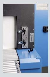
Un régulateur de température digital permet l'ajustage d'une température constante jusqu'à 250 °C maximum.
